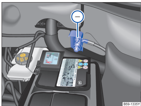
图 211 用于充电器负极连接的接地点
