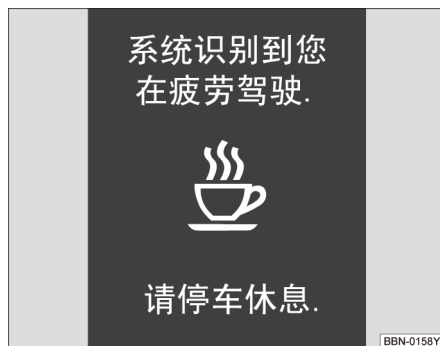
图 17 组合仪表显示屏：疲劳警告符号
