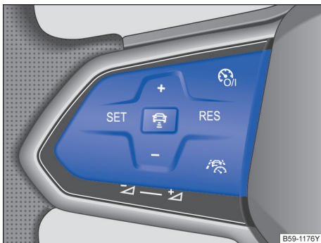
图 149 多功能方向盘左侧：操作半自动驾驶辅助系统(Travel Assist)的按钮
