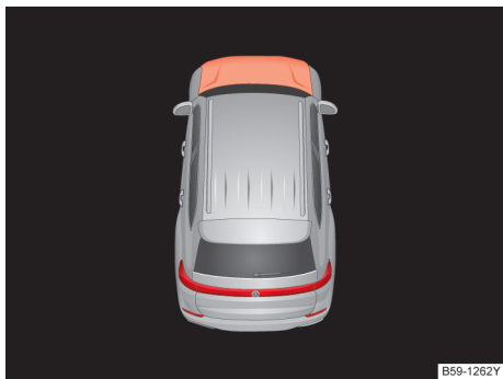
图 16 在组合仪表的显示屏上：发动机舱盖打开或未正确关闭
