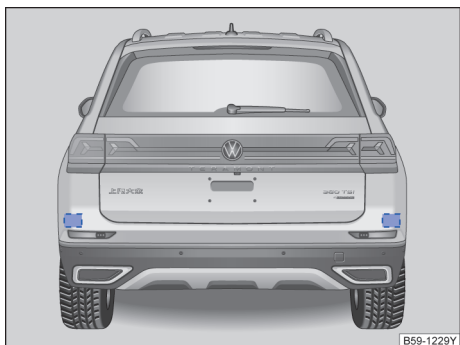
图 151 车辆后视图：雷达传感器部位
