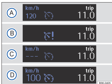
图 138 组合仪表显示屏：定速巡航系统状态显示
