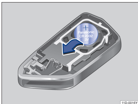
图 50 汽车钥匙：更换纽扣电池
