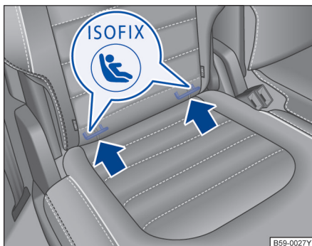
图 42 汽车座椅上的儿童座椅下部固定点标记。
